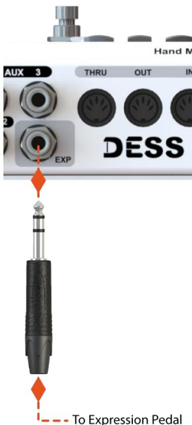
Le connecteur "Exp" (jack TRS ¼") est une entrée permettant le branchement d'une pédale d'expression. Celle-ci permettra le contrôle des volumes/Gains interne de l'appareil mais également d'envoyer des messages Midi en contrôle continu permettant le contrôle en temps réel des pédales équipées de la technologie Midi.
