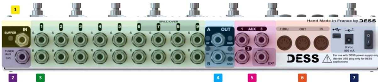
1 Section Input, permet de connecter la source audio qu'elle soit basse ou haute impédance. Le commutateur « buffer » permet d'abaisser l'impédance à l'entrée du switcher afin d'envoyer un signal basse impédance dans le reste de la chaîne.
