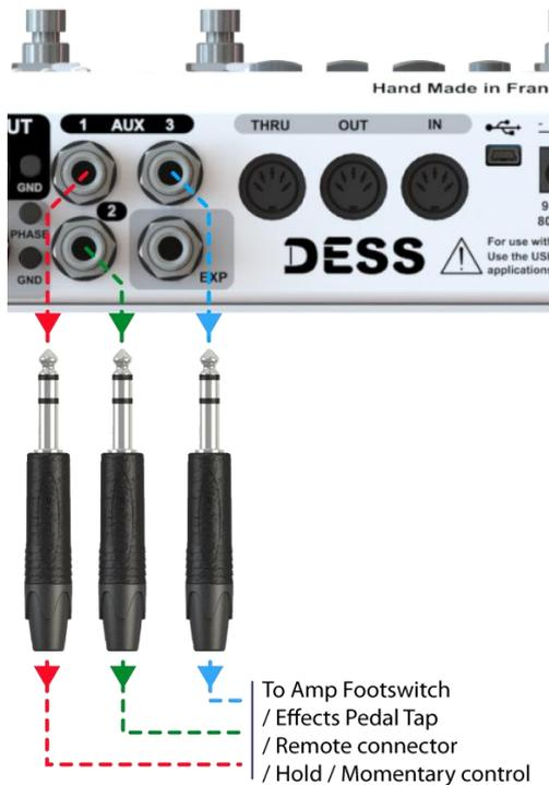
Les connecteurs Auxiliaires (jack TRS ¼") numérotés de 1 à 3 sont des sorties permettant le branchement de la prise "Footswitch" d'un ampli ou encore le branchement de prise "Remote" ou "Tap" de certaines pédales d'effets.
