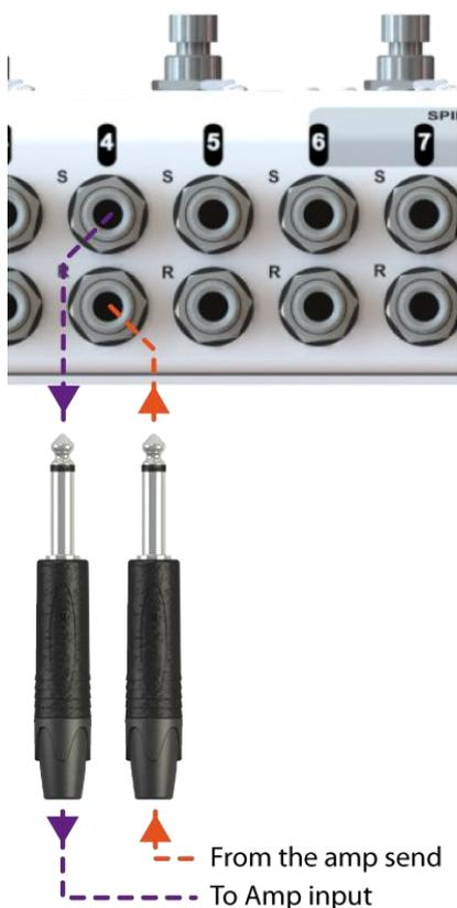
Les connecteurs Send (S) et Return (R) (jack mono 1/4") numéroté de 1 à 9/12 sont respectivement des sorties et des entrées permettant le branchement de boucle d'effets d'amplis.
